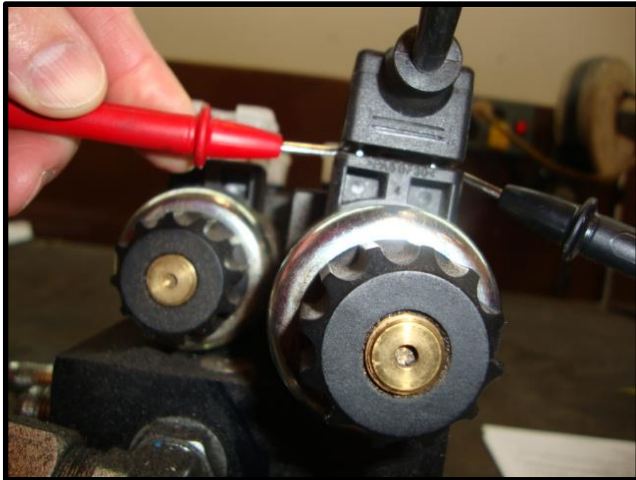
Fig. 8-4 Checking Din Plug Voltage
